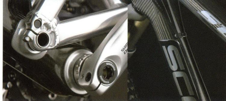
Wie bei allen gefederten Scott Bikes verwenden wir nur qualitativ hochwertige und gedichtete Kugellager für ultralange Lebensdauer und Geräuschlosigkeit.
