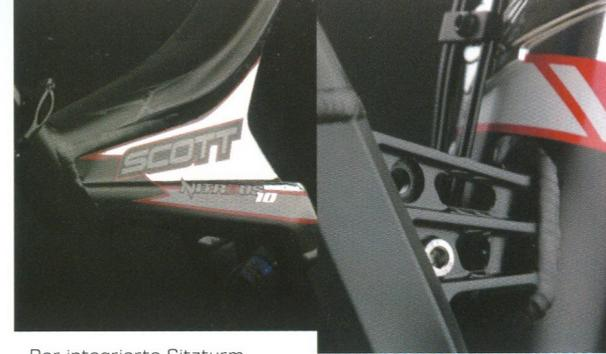
Der integrierte Sitzturm und das Octagon Oberrohr erhöhen die Steifigkeit für messerscharfes Handling und präzises Lenken.
